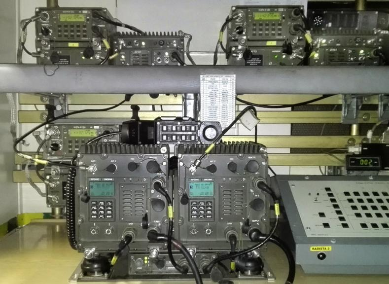
El repetidor automático AR20 es un dispositivo utilizado en operaciones de transceptores de frecuencia fija, conforme a los requisitos de STANAG 4204 y transceptores comunicantes en forma de salto de frecuencia con HW20, es decir, transceptores RF20, RF2050, RF23, RF2350.
