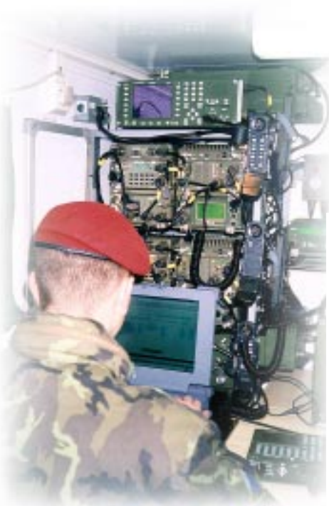
Obr. 1 Vnitřní uspořádání komunikačních prostředků mobilní přístupové provozovny MPP 40p LR
