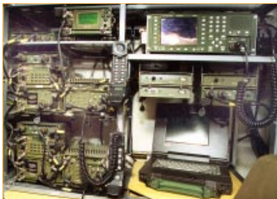
Obr. 2 Zástavba rádiových stanic ve vozidle
