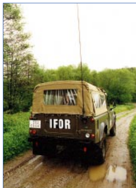
Obr. 4 Mobilní prutová anténa na terénním vozidle
