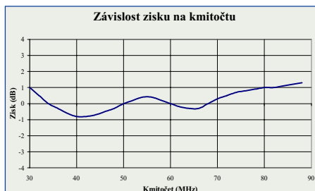
Obr. 2 Typický zisk antény GROUNDPLANE vztažený k λ/4 prutu na 8 m stožáru
