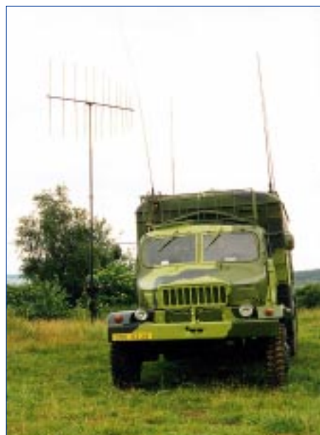
Obr. 3 Logaritmicke-periodická anténa na stožáru 9 m
