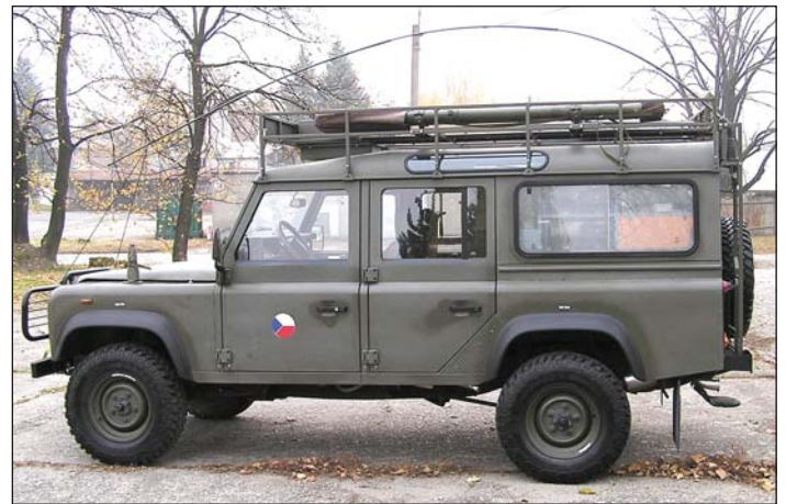
Obr. 3: Umístění KV antény na vozidle (sklopený stav)
