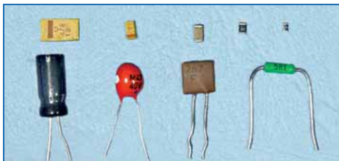
Obr. 1 Srovnání rozměrů pouzder odporů a kondenzátorů v klasickém a SMD provedení
